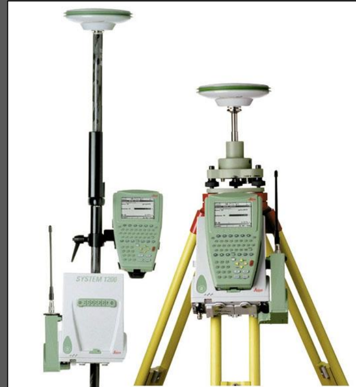
Georeferenziazione dei punti presi con la stazione totale (base + rover)
